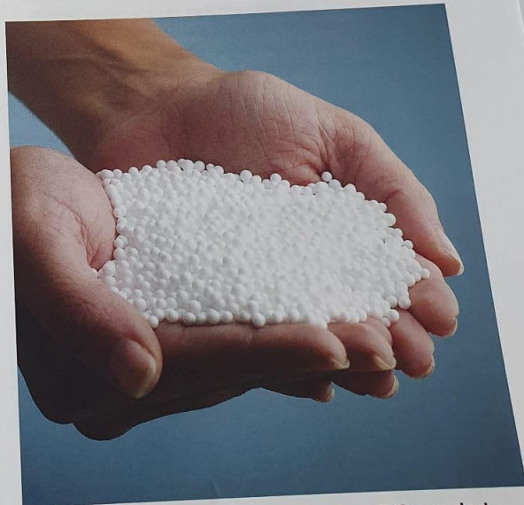
Het eindproduct van PolyStyreneLoop is schoon EPS-granulaat. (Foto: Knauf Industries)
